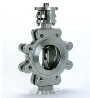
Корпус с направляющими отверстиями для монтажа ответных фланцев для использования заслонки в конце трубопровода. Трубопровод может быть прифланцеван с одной стороны в рекомендованном направлении подачи давления (обозначение стрелкой на корпусе) прямо за заслонкой.
